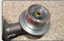
Montieren Sie das Kopf unterteil.
